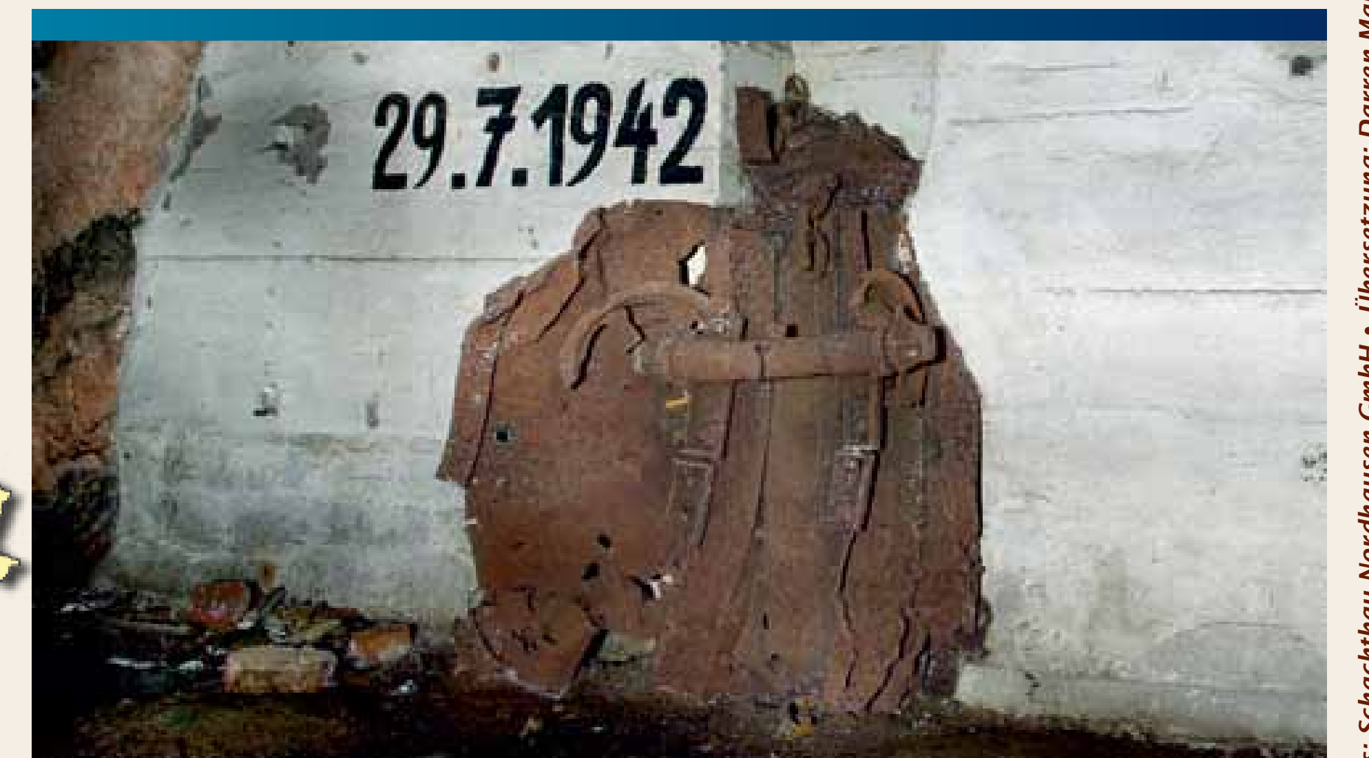
Plattgedrückter Förderwagen am Ort der Explosion
