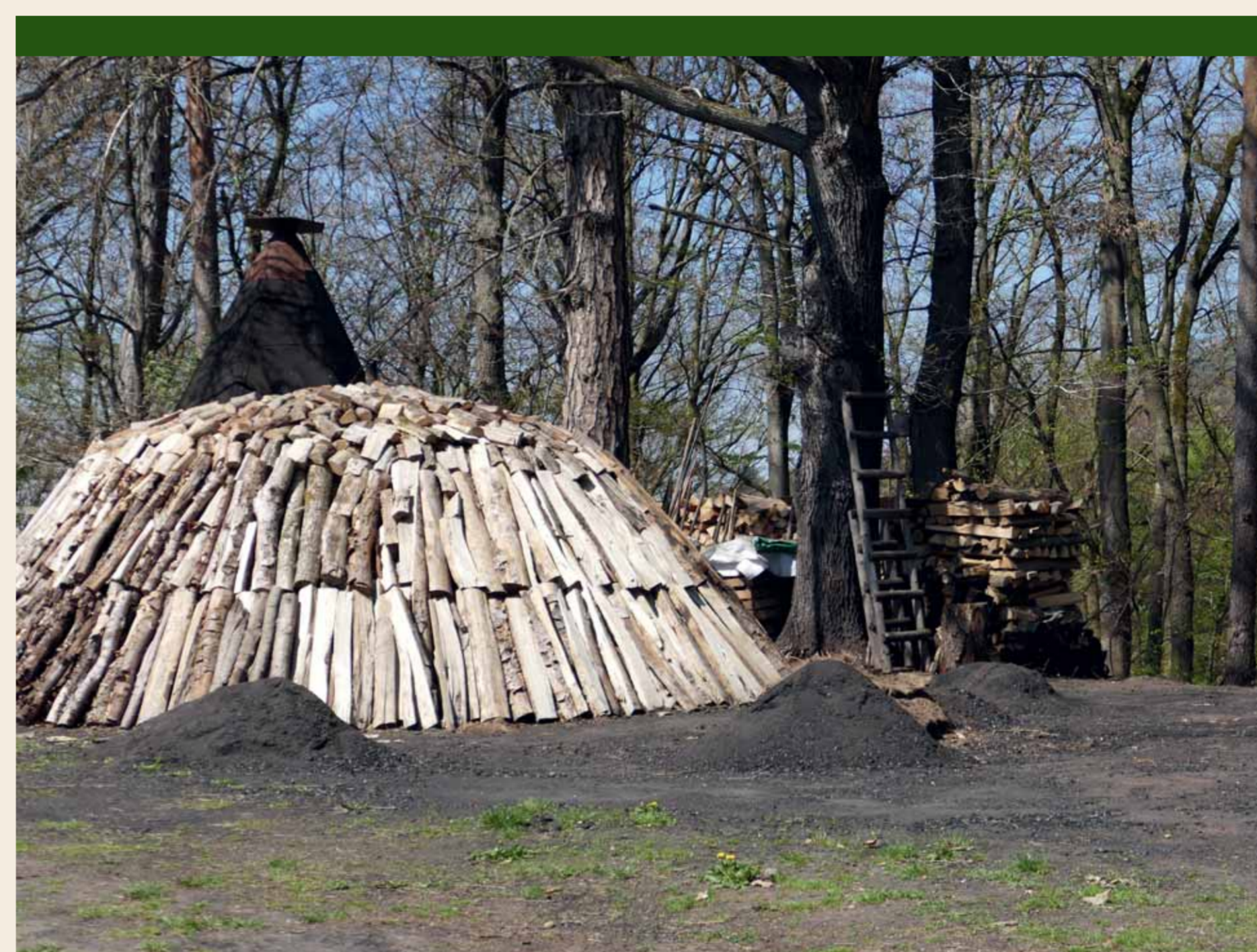
Innenleben eines Kohlemeilers: aufgeschichtete Laubhölzer
