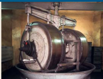
Kantsteen in de buskruitfabriek
