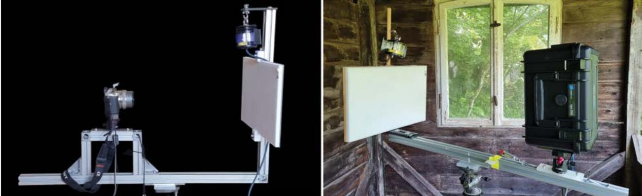
Prototypen der in Jena seit 2021 eingesetzten Kamerafalle. Insekten werden mit einer UV-Insektenlampe angelockt, setzen sich auf einen weißen Schirm (24 x 36 cm) und werden dort in Intervallen fotografiert.
